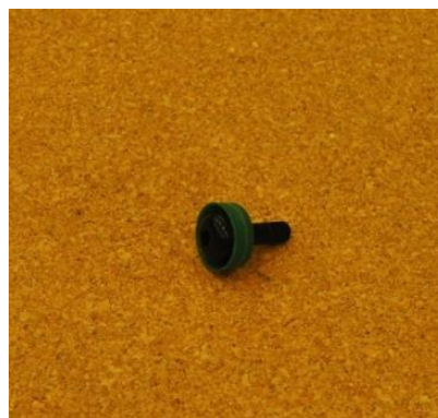
Obr. 2 Vrchnák s otvorom a vsadeným ventilom
